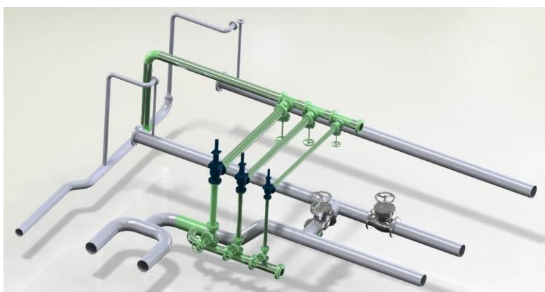
Figura 13. Projeto do sistema de teste de PRVs montado no Oleoduto de Teste
