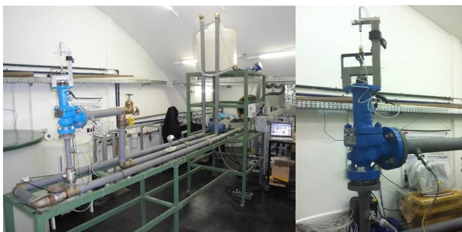
Figura 10. Fotografia da bancada experimental e detalhe da PSV instrumentada
